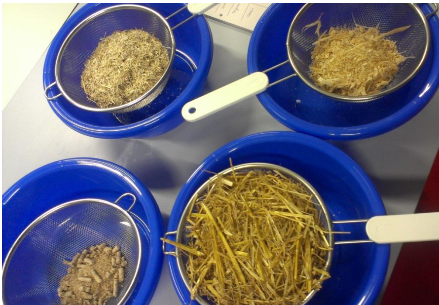
Abbildung 4 : Labortest der Saugfähigkeit von Einstreumaterialien
