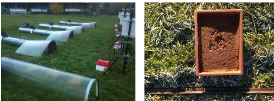
Abb. 2a, 2b: Aufbau Windtunnel am Messplatz, Schale mit EQ-Bedding vor Abdeckung mit dem Windtunnel
